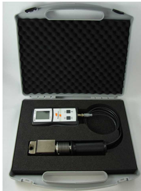
Prüfkoffer mit Kraftaufnehmer und mobilem Anzeigegerät Test Kit with Force Transducer and Handheld Indicator
